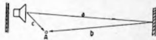
Fig. 1 - GEEN ECHO-EFFECT als de weg a + b kleiner is dan c + 20 meter
